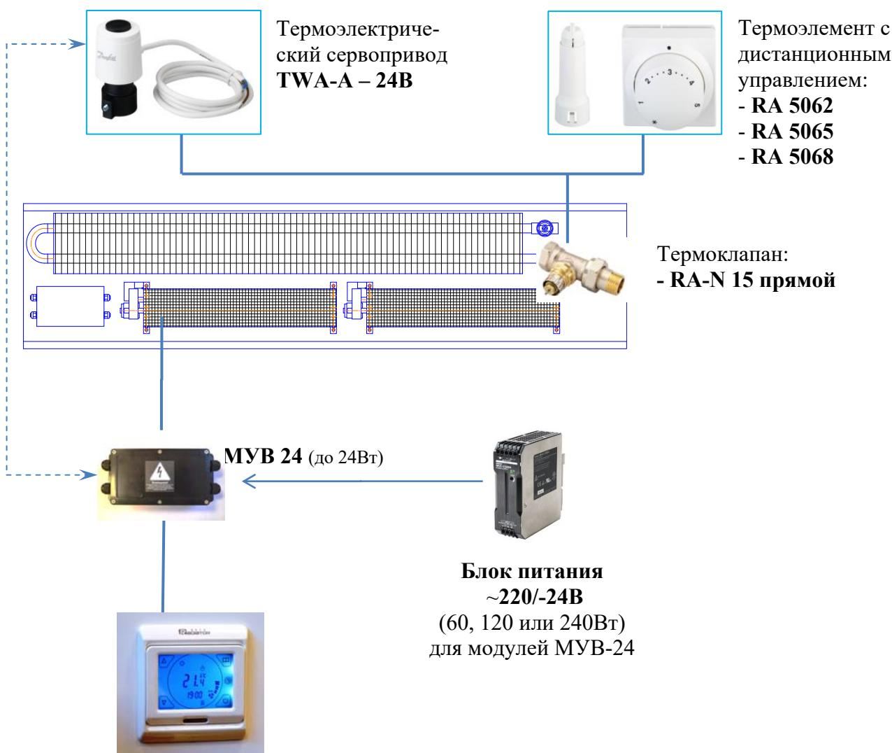
**ЭТПР - настенный терморегулятор (Упит ~220В) с сенсорным управлением и плавной регулировкой вентиляторов**
