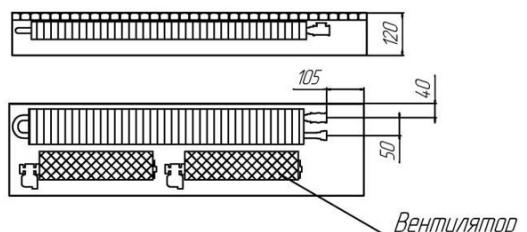
**Вентилятор****Конвектор Бриз В шириной 380 (вид сверху)**
