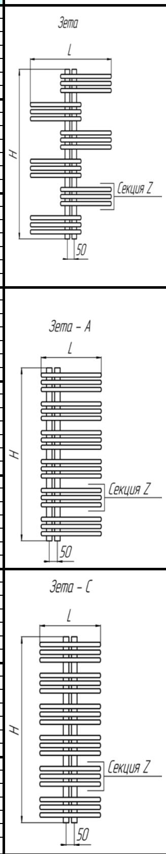
Пример обозначения: «Зета - Z - L», где Z - количество секций, L - ширина прибора
